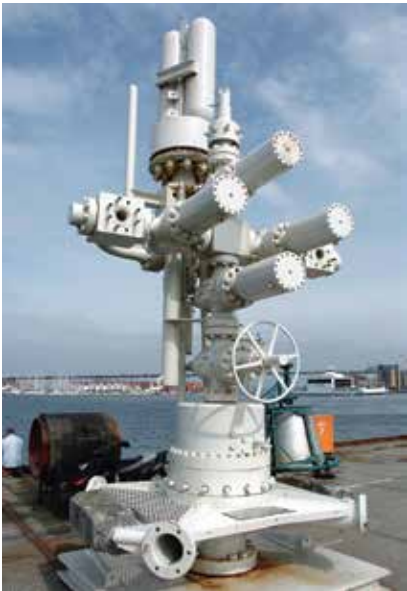
De fire ventiltrærne som produserte olje på havbunnen på Ekofisk i 1971 måtte betjenes manuelt av dykkere. Et av dem er bevart og står på kaien utenfor Norsk Oljemuseum. Foto: Norsk Oljemuseum
